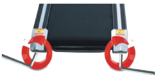
Slika A Podešavanje ako traka ide udesno
